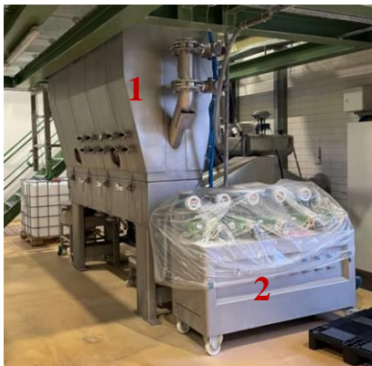
Câmara de Leito fluidizado (1) com unidade de dosagem e pulverização (2)
