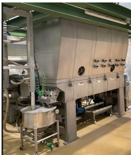
Câmara de leito fluidizado c/ transporte a vácuo, para enchimento de bigbags
